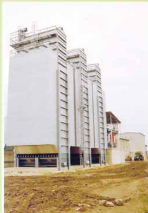
Essicatoi a riciclo tipo BPV antipolvere da Ton. 234 di carico
